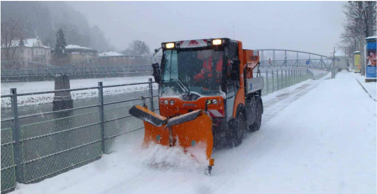
Abbildung 68: Winterdienst auf Radwegen mit einer speziellen, schmalen Räumungsmaschine (Quelle: https://www.salzburgrad.at/gemeinden/winterdienst )
