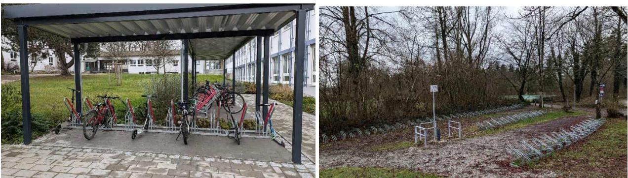
Abbildung 50: Hochwertige Hoch-Tief-Aufsteller mit Anlehnbügeln (links, Otfried-Preußler-Schule) oder nicht sichere Vorderradhalter (rechts, Simssee)
