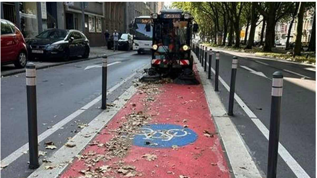
Abbildung 67: Radwegreinigung mit einer speziellen, schmalen Kehrmaschine (Quelle: Aachener Zeitung; Foto: Stadtbetrieb Aachen)
